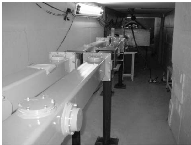
Рис. 4. Первые секции изогнутых нейтронных волноводов ЭПСИ-ЛОН (слева) и СКАТ (справа) (сотрудничество с Германией)
