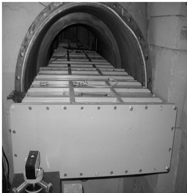
Рис. 2. Головная часть рефлектометра GRAINS, установленная в кольцевом коридоре реактора ИБР-2М (сотрудничество с Германией, Венгрией, Румынией)
