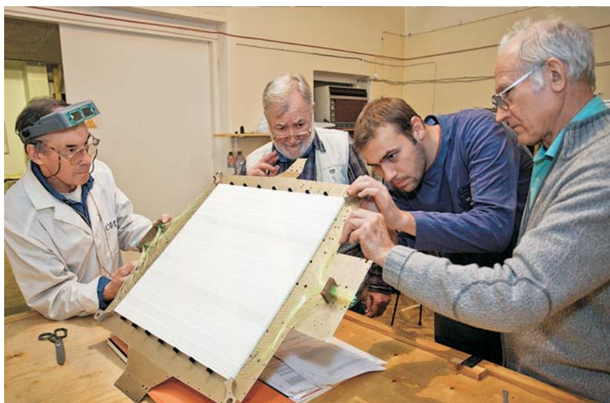
Лаборатория ядерных проблем им. В. П. Джелепова. Сборка триггерного модуля полетного образца детектора НУКЛОН
