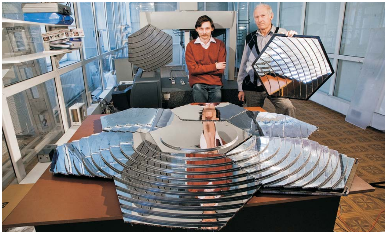
Лаборатория ядерных проблем им. В. П. Дзелепова. Технологический образец фокусирующего зеркала для работы в открытом космосе, созданный в ОИЯИ в рамках космического эксперимента ТУС
